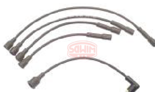
PRZEWODY ZAPŁONOWE SILNIK: H20
