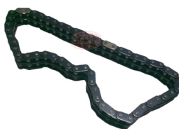
ŁAŃCUCH ROZRZĄDU SILNIK: H20
