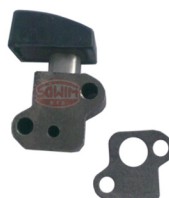
NAPINACZ ŁAŃCUCHA SILNIK: J15
