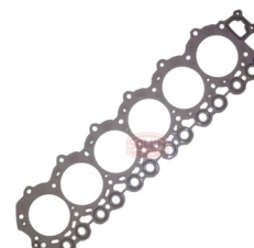
USZCZELKA GŁOWICY SILNIK: TB42
