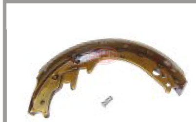
SZCZĘKA HAMULCOWA MODEL: D02 (PO 2004 R) NA LEWE KOŁO
