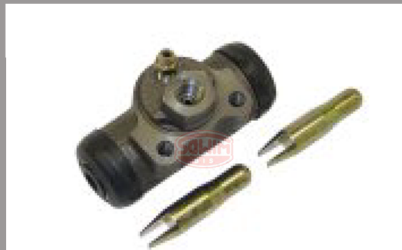
CYLINDEREK HAMULCOWY MODEL: D01, L01
